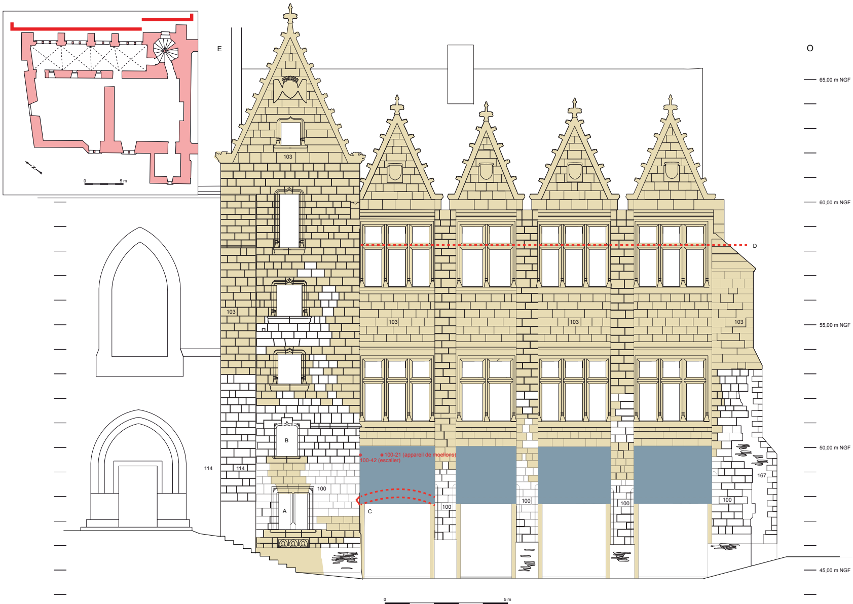
Fig. 48 : Élévation de la façade nord du logis royal (G. Mestier de Parajid ACMH). Interprétation et localisation des prélèvements de mortier. Les parties figurées en jaune correspondent aux pierres de taille changées dans les années 1950. A : fenêtre utilisée comme porte au XVII e siècle ; B : fenêtre utilisée comme porte dans la seconde moitié du XIX e siècle ; C : embochement (UA 240) lié à l'installation d'un des arcs qui portaient la façade avancée, probablement édifiée au XVII e siècle ; D : Niveau de l'égoût du toit à partir des années 1780.
